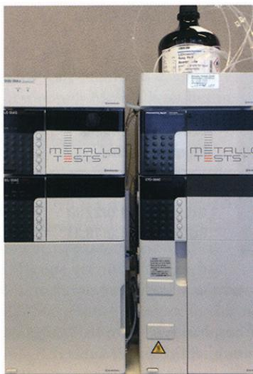
Abbildung 1 Nexera UHPLC-System mit Photodiodenarray-Detektor
